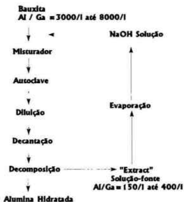
Figura 1 - Processo Bayer para a Fabricação de Alumina
