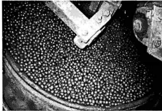
Figura 01 – Disco de pelotização com pelotas de minério de ferro
