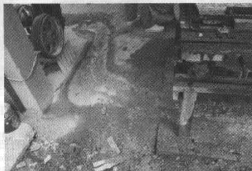
Figura 02: Geração de lama contendo finos do corte das rochas.
