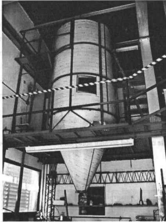
Figura 2: Cámara para secado spray de octoborato de Sodio
