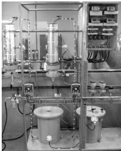
Figura 3 – Vista frontal do sistema de lixiviação bio-assistida.
