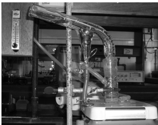
Figura 1: Tubo de Hallimond modificado convencional sem adaptação de prolongamento.
