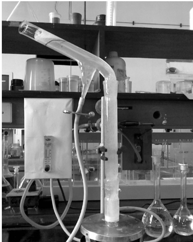
Figura 2: Tubo de Hallimond modificado convencional com adaptação de prolongamento.
