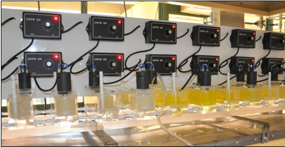
FIGURA 5. Instalação micro piloto para a realização dos experimentos contínuos – células misturadores/decantadores.
