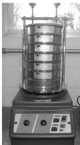
Figura 1: Ensaio de distribuição granulométrica.
