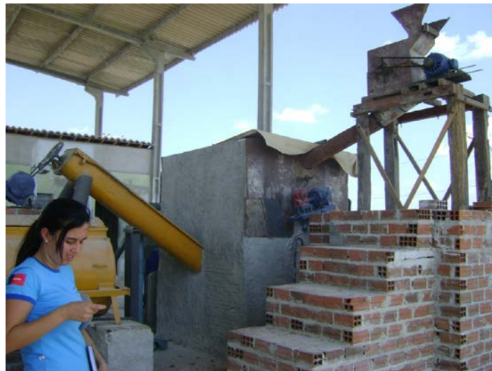
Figura 4- Mostra o moinho de martelos (à direita e acima), peneira cilíndrica (trommel) enclausurada, e transportador de rosca, alimentando os misturadores, à esquerda (tom amarelo).
