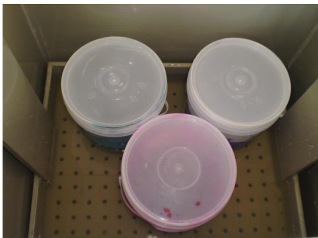
Figura 3. Recipientes plásticos vedados contendo as gemas imersas nas soluções tingidoras para aquecimento em banho maria no tanque de tingimento.
