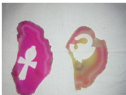
Figura 6. Chapas de ágata, de mesmo lote, tingidas com corante rodamina B. À esquerda, amostra submetida ao escuro por trinta dias e à direita, amostra exposta à radiação solar pelo mesmo período.
