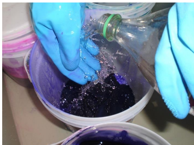
Figura 4. Primeira lavagem das gemas com álcool combustível, após serem removidas da solução tingidora.
