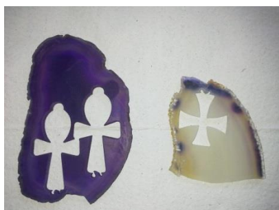
Figura 5. Chapas de ágata, de mesmo lote, tingidas com corante cristal violeta. À esquerda, amostra submetida ao escuro por trinta dias e à direita, amostra exposta à radiação solar pelo mesmo período.
