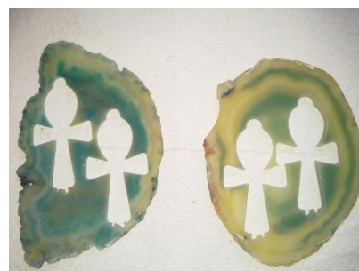
Figura 7. Chapas de ágata, de mesmo lote, tingidas com corante verde brilhante. À esquerda, amostra submetida ao escuro por trinta dias e à direita, amostra exposta à radiação solar pelo mesmo período.
