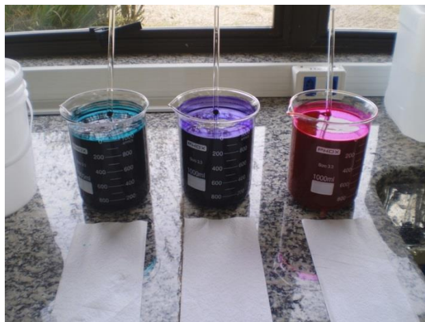
Figura 2. Sistemas em decantação contendo as soluções tingidoras de pigmentação com verde brilhante, cristal violeta e rodamina B, da esquerda para a direita, respectivamente.
