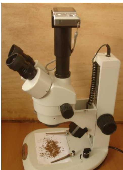
Figura 2. Montagem do microscópio estereoscópico ZOOM645 da Diagtech utilizado para a aquisição das imagens.
