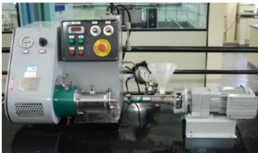
Figura 2. Moinho IsaMill de laboratório de 1 litro do Centro de Desenvolvimento Mineral da Vale S.A.
