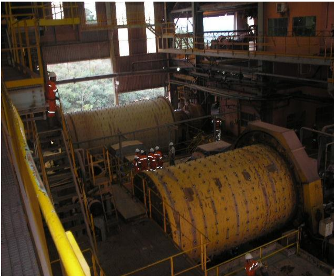
Figura 1. Circuito de moagem da JMC mostrando os moinhos 1 (direita) e 2 (esquerda).
