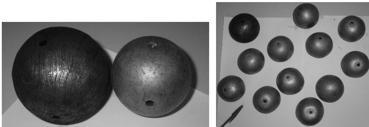
Figura 4. Comparação das bolas antes e depois da moagem.
