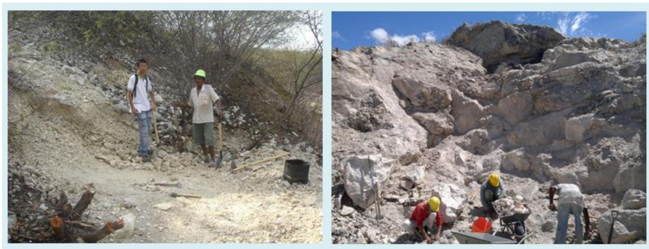
Figura 2. Atividade garimpeira em pegmatito do município de Picuí-PB, mostrando o uso de instrumentos rústicos na extração e transporte do minério ausência de EPIs e condições insalubres de trabalho.
