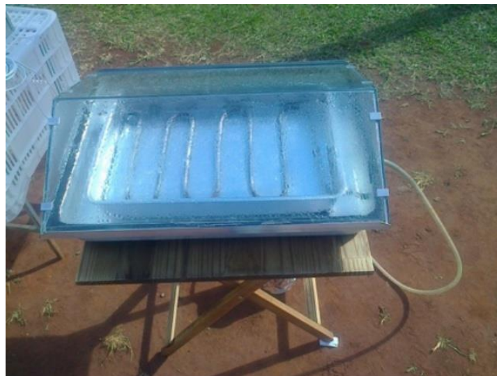
Figura 1. Evaporador solar de simples efeito e baixo custo.
