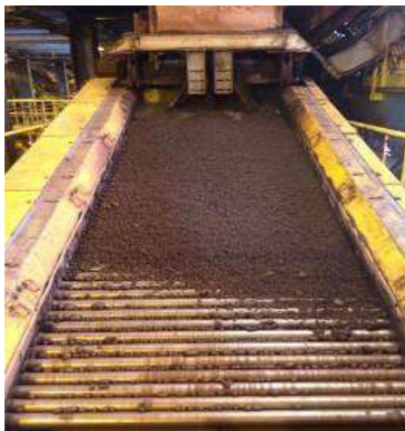
Figura 1. Processo de classificação de pelotas em peneira de rolos (SILVA, 2017).
