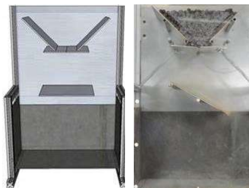
Figura 6. Imagem em CAD do dispositivo de bancada para o teste de manuseio (esquerda) e imagem do teste (direita).
