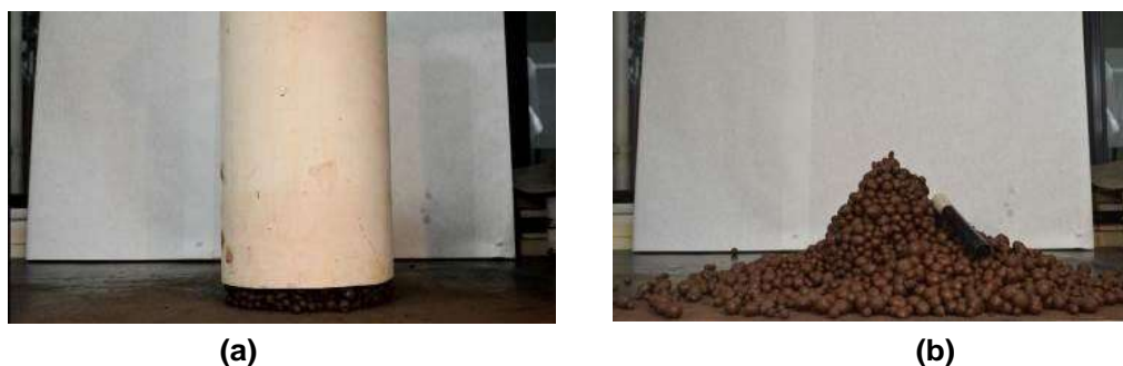
Figura 3. Teste do ângulo de repouso (a) remoção do cilindro (b) perfil final da pilha.
